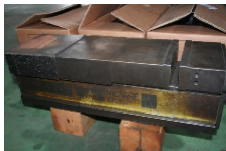
NO.4 ツダコマ マシンバイス VZ200 口元200mm
